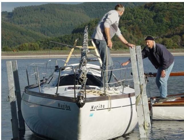
Einfahrt zwischen die Rungen des Slippwagens.
