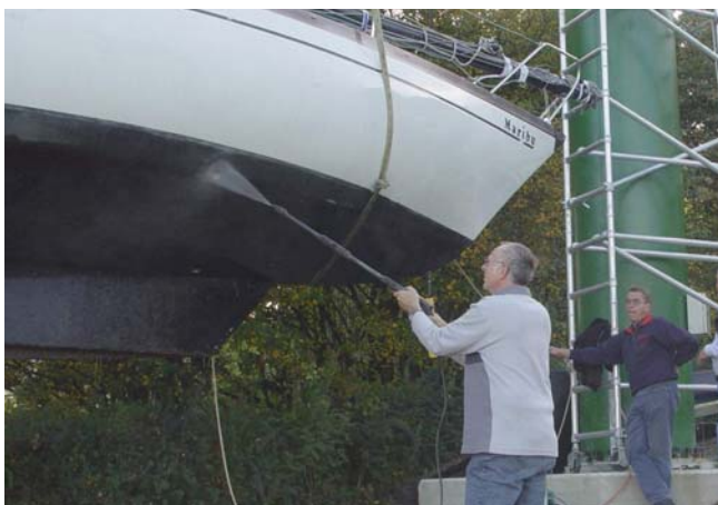
An Ort und Stelle wurde das Unterwasserschiff mit dem Hochdruckreiniger abgespritzt.
